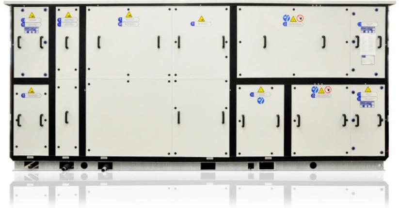
Außen- und Innengeräte sind ideal für den jeweiligen Einsatzzweck gerüstet. So wird z.B. bei Außengeräten gesichert, dass wasserführende Leitungen im Winter nicht einfrieren können. Ein geschweißter Sockel erhöht die Stabilität. Der direkt im Gerät angebrachte Reparaturschalter vereinfacht die Wartung, da direkt vor Ort Ventilatormotoren ausgeschaltet werden
