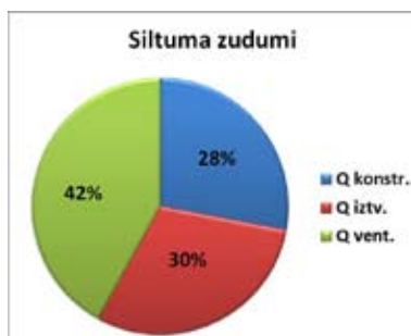
1. att. Baseina telpas siltuma zudumu procentuāls sadalījums. Attēlā redzams, ka lielākie siltuma zudumi baseina telpās saistīti ar ventilāciju, proti, ar svaigā gaisa uzsildīšanu.
